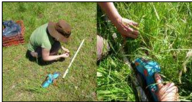
FIGURE 7 : LES ÉCHANTILLONS D'HERBE ONT ÉTÉ PRÉLEVÉS À L'AIDE D'UNE CISAILLE À GAZON GARDENA ET D'UN MÈTRE EN BOIS
